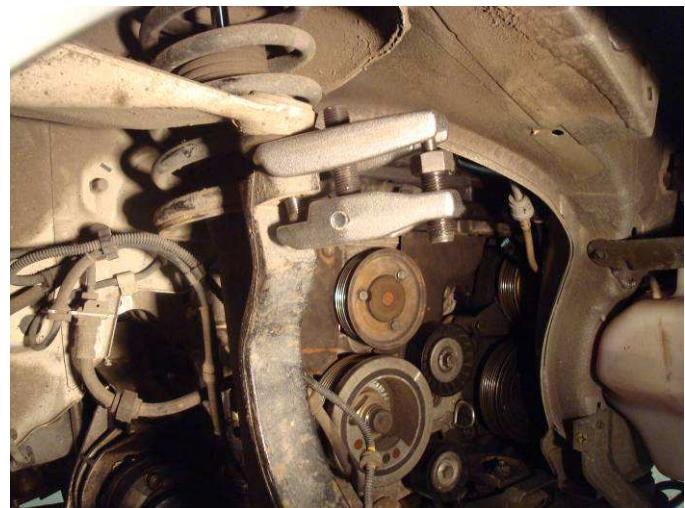
Dévisser les écrous de fixation du bras oscillant supérieur de la suspension AV à la coque.
