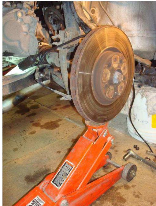
1. Dévisser l'écrou (1a) et déconnecter le bras oscillant supérieur (1b) du montant de moyeu AV à l'aide de l'outil (1c).
