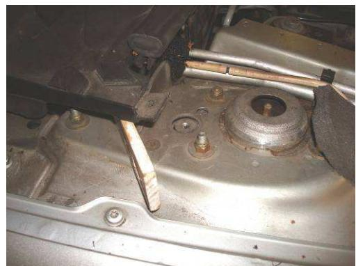
Visser le boulon qui fixe la fourchette d'amortisseur AV au bras oscillant, côté bras oscillant.
