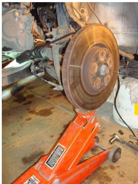
Soulever et connecter le bras oscillant supérieur (1b) du montant de moyeu AV .
