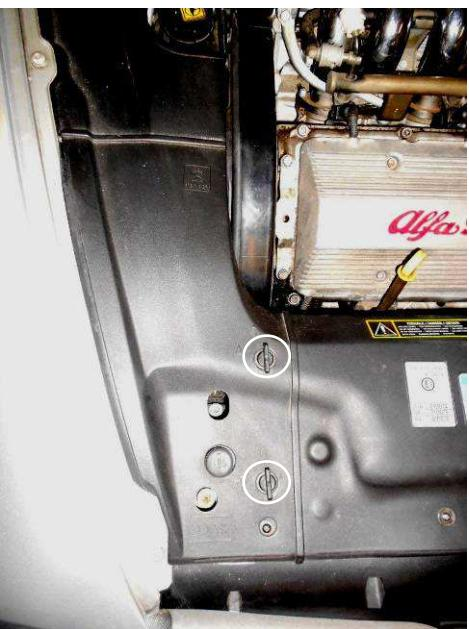
Enlever le clips (1a) et dévissez les vis (1b), Démonter le cache arrière gauche (1c).
