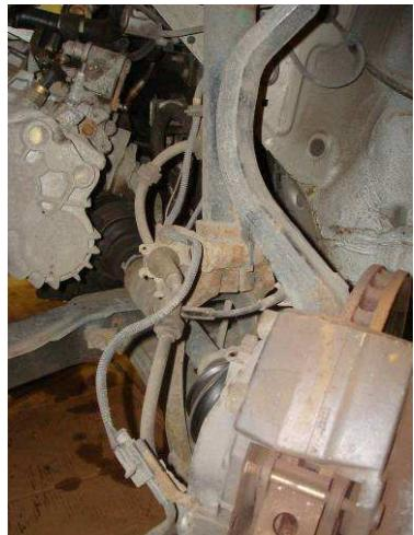
Dévisser le boulon qui fixe la fourchette d'amortisseur AV au bras oscillant, côté bras oscillant.
