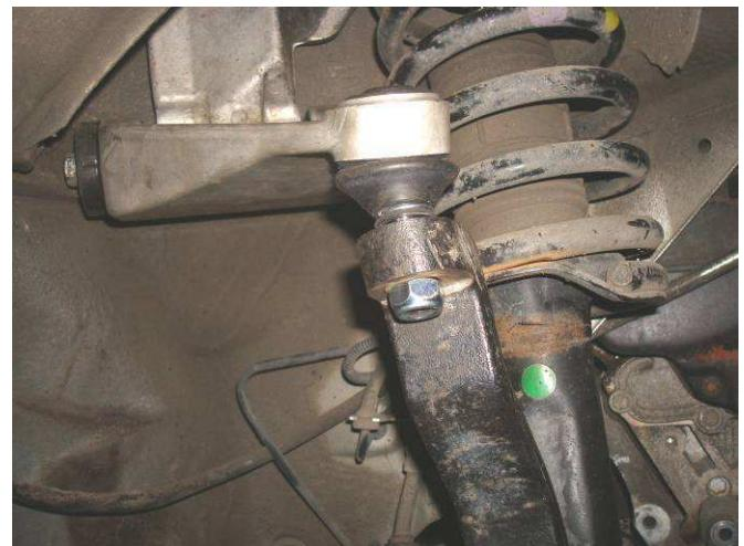
Rengager le flexible d'étrier de freins AV dans l'étrier de support. remonter l'agrafe
